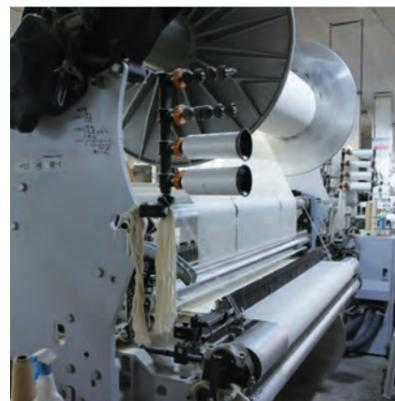
補助金で導入したレピア式織機
