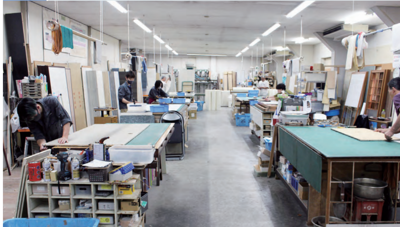
ふすまの貼り換え作業風景
