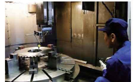
ターニング旋盤にて孔仕上げ
