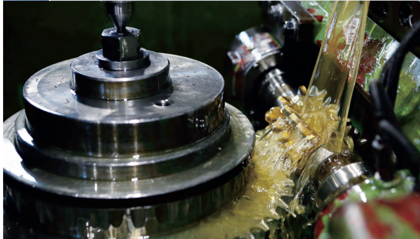
ステンレス sprocket 歯切り加工
