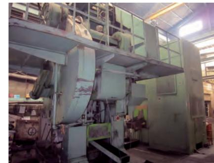
大型ナックルジョイントプレスで大物加工に対応
