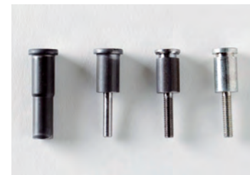
精密ネジ完成までの製造工程
