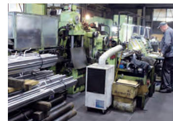
ピーリング工程の作業
