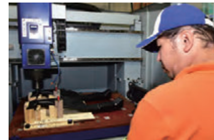
成形後の穴あけ作業の様子
