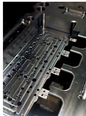
金型の外周部を構成する部品(モールドベース)
