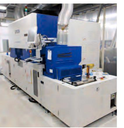
導入したUVインクジェット印刷機
