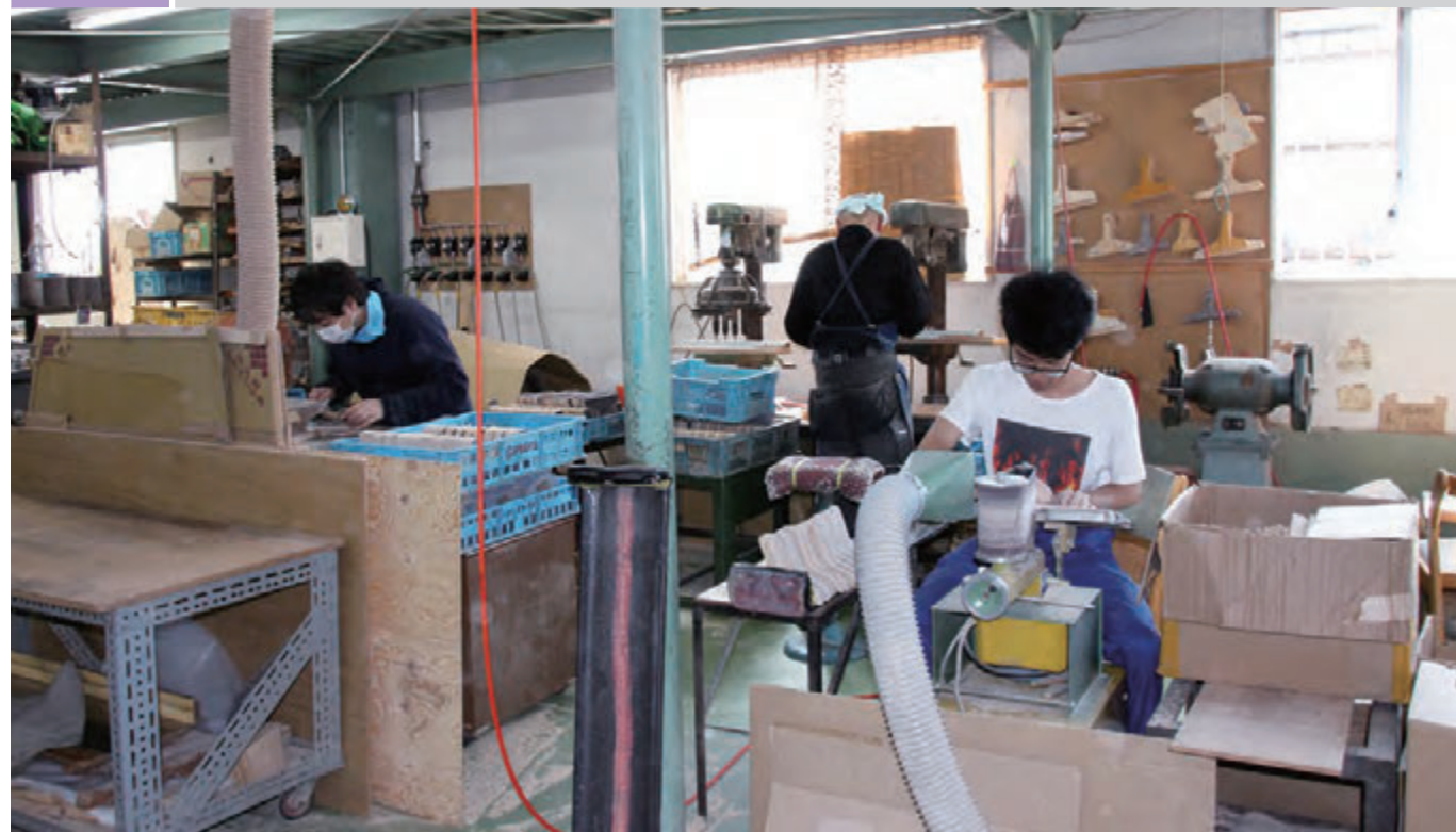
面取りや穴開けなどの工程
