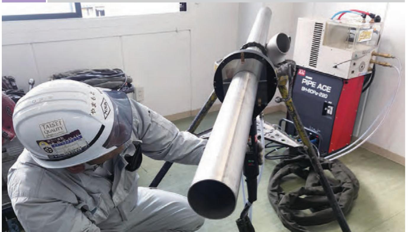
パイプエースで配管自動溶接する風景
