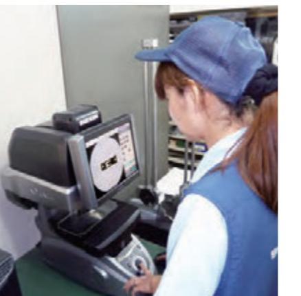
補助事業で導入した画像寸法測定器
