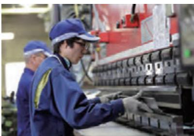
長尺のアール曲げ加工の工程
