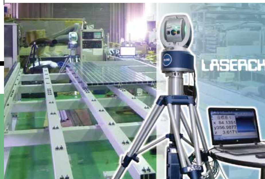
導入した「レーザートラッカー」
