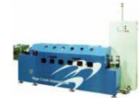
磁気軸受式チューブラー型燃線機
