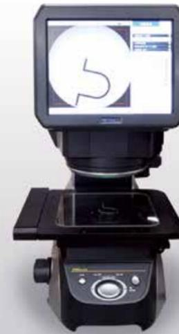
導入したCNC画像寸法測定器
