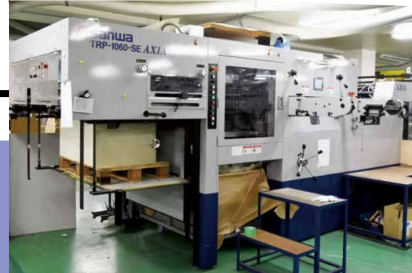
新たに導入した自動平盤打抜機
