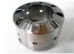
エンジン用燃料噴射系試作部品
