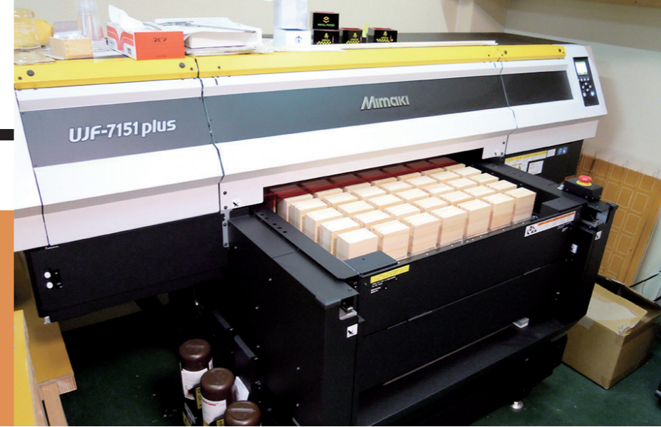
導入したUVインクジェットプリンターによる加工
