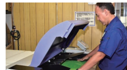
印刷データから刷版を製作
