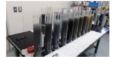
土の粒度試験や沈降分析も実施する
