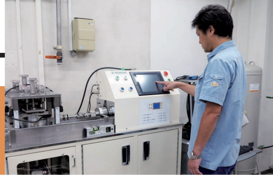
さまざまな試料に対応できる「改良型一面せん断試験機」
