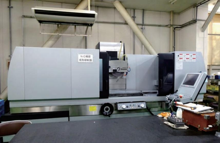
導入した3次元平面研削盤
