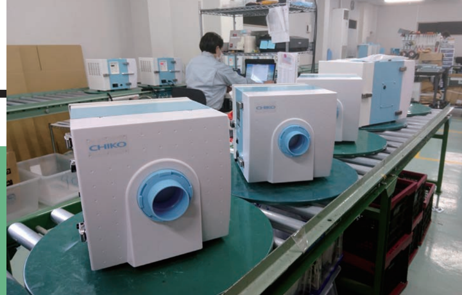
本場で組み立てている集塵機
