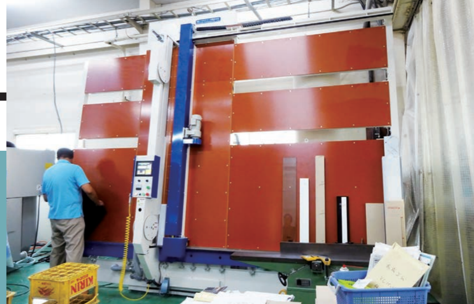
導入した八尺自動パネルソー
