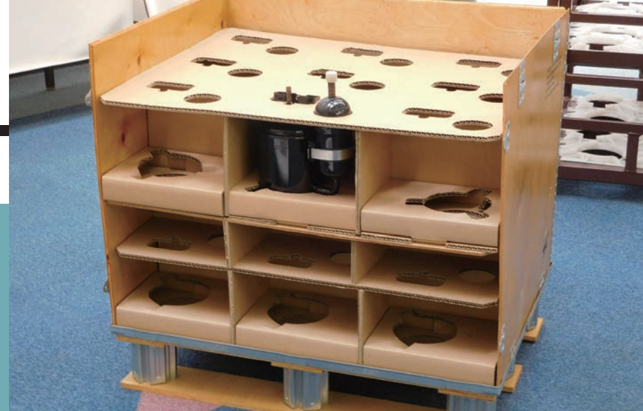
アイロップが設計している部品輸送用の包装
