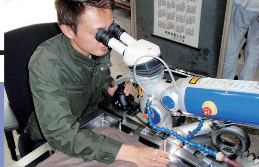
ドイツ・アルファレーザーの大型精密レーザー溶接機「ALM250」
