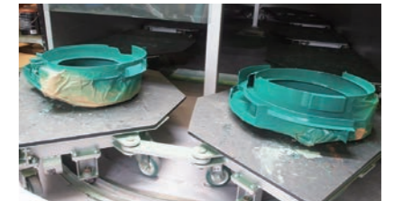
恒温・恒湿乾燥能付きパレットコンベヤ
