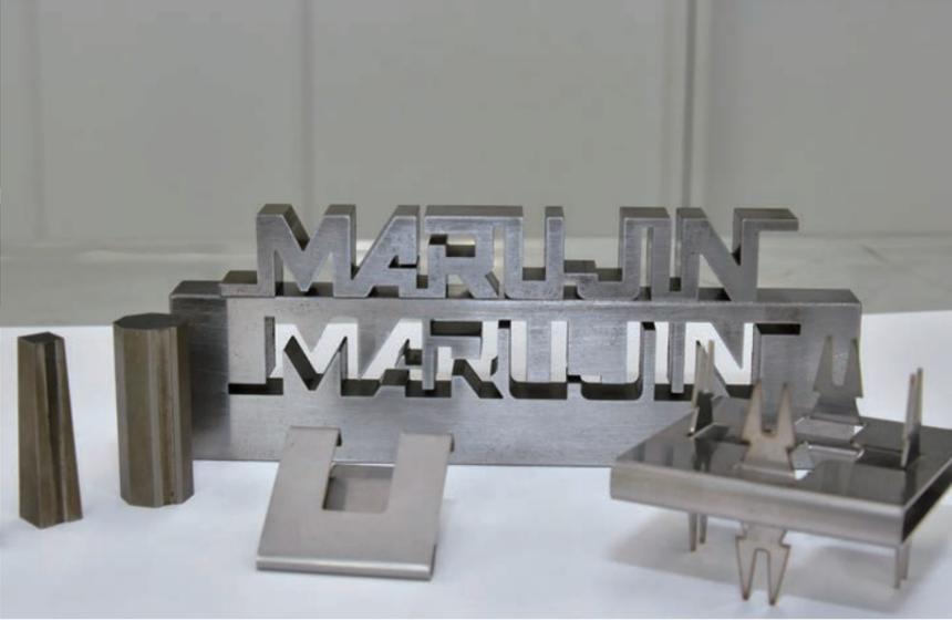
ワイヤ放電加工機による試作品
