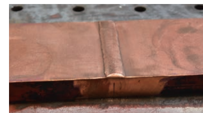
溶接した厚さ20mmの銅板
