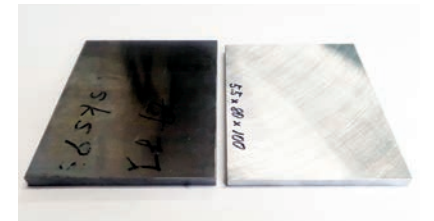
脱炭層(黒皮)除去前(左)と除去後(右)のゲージ鋼板
