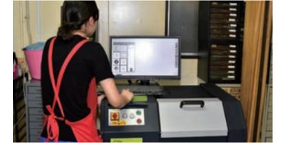
レーザー式直接描画装置
