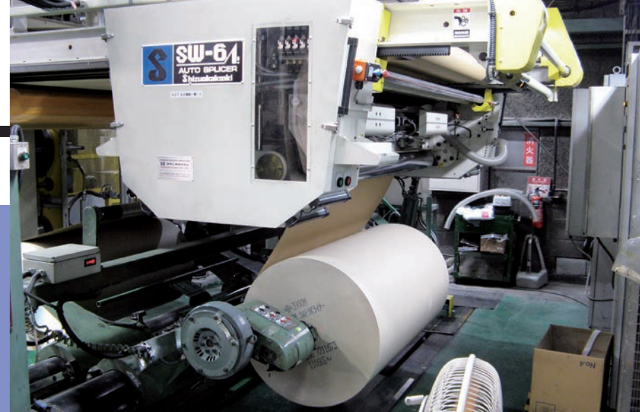
速度を落とさずに紙継ぎができるオートスプライサー
