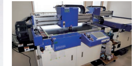
木型の雛型を製作する面版加工機
