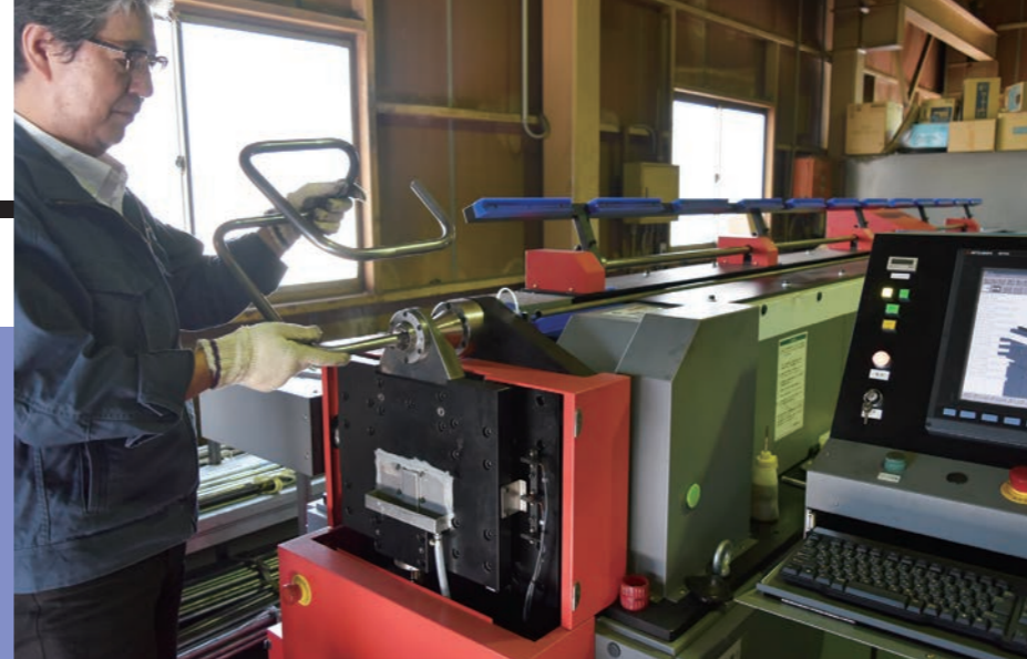
導入した3次元パイプベンダー
