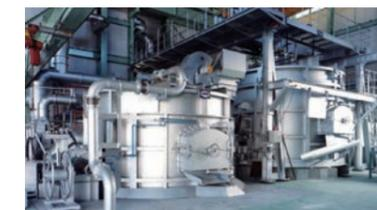
アルミニウムを溶かす溶融炉
