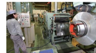
泉南工場に新設の脱脂洗浄ライン
