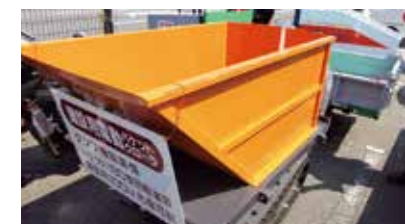
180°回転する建設用クローラー
