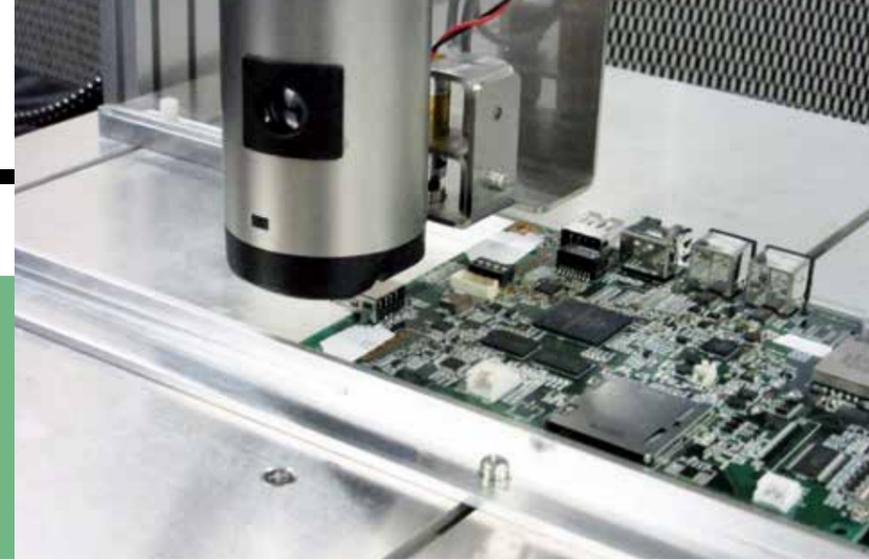
プリント基板への印字の瞬間
