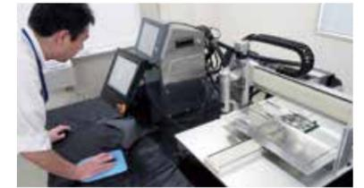
電子回路実装基板用プリンティングロボット
