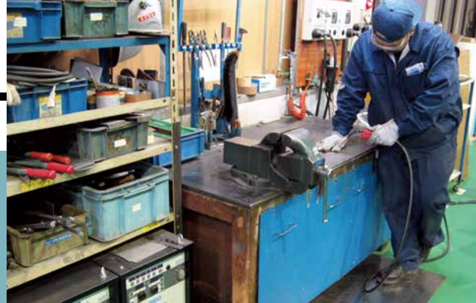
デジタル溶接機で安定化した溶接作業
