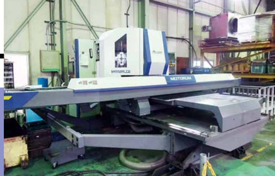
4mの金属板を加工できるタレットパンチプレス
