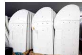
ABS樹脂で作られた 精米機に取り付ける プレート
