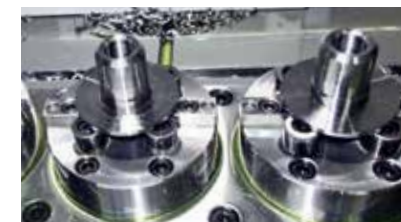
前加工をしたガイドスクリューをMC治具にセットした加工前の状態
