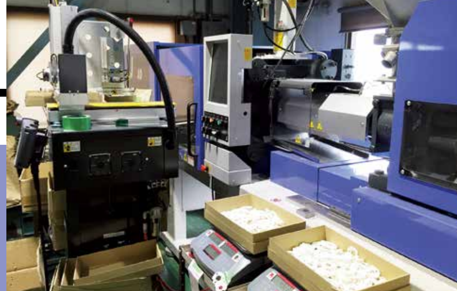
導入した電動射出成形機と自動ニッパ
