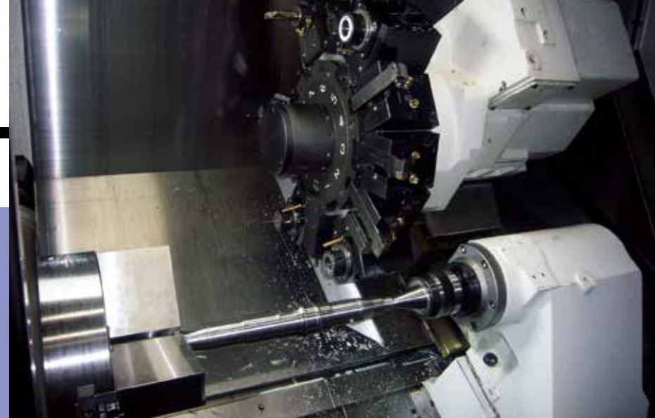
稼働する複合NC旋盤
