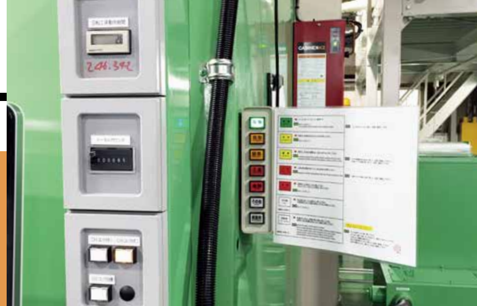
加工機械に取り付けた無線式スイッチ
